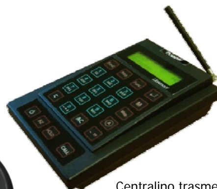
Centralino trasmettitore con tastiera digitale a sfioramento "touch"
